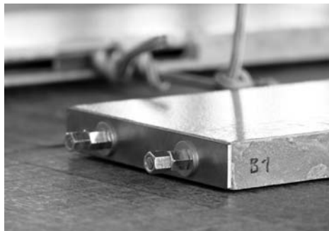
(d) Prestressing threads and counteracting nuts
