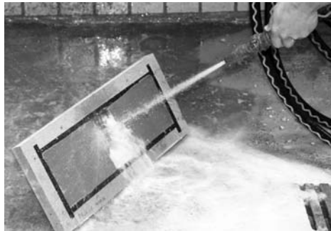
(d) Washing off the mortar sealing
